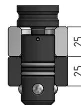
Perno di bloccaggio a 4 sfere L= 50 mm
