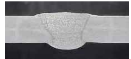
Head to head 4 mm aluminium welding. Excellent weld pool penetration and stability. Saldatura alluminio testa a testa 4mm. Ottima penetrazione e stabilità del bagno.
