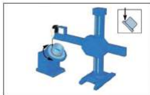
Saldatura su posizionario a tavola rotante Welding on a positioning table Сварка совместно со сварочными вращателями Soudage sur un positionneur a table tournante Schweißen auf einem Drehtisch Soldadura en una mesa giratoria
